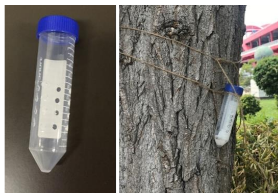
図2 遠沈管トラップ (左) および設置風景 (右)
